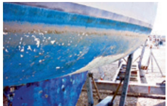
Burbujas y desprendimientos
